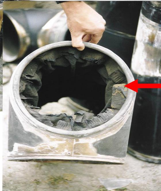
*Die Dämmung ist hier geschmolzen und das Metall-Innenrohr ist ausgeglüht.*
